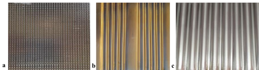
Fig. 2. Geometrías sobre la superficie de los electrodos: a) pines; b) ondulados I y c) ondulados II.
