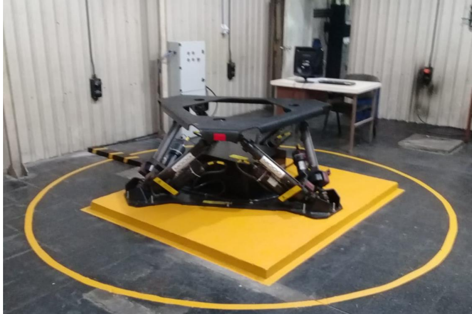
Fig. 1. Plataforma de movimiento MOOG 6DOF2000E instalada y operativa.
