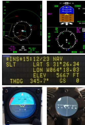
Fig. 15. Vista de las MFCU en parte superior de la imagen, vista del UFCU simulado en parte media, y vista de los dispositivos emulados horizonte de emergencia (izquierda) y brújula (derecha) en la parte inferior.
