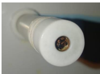
Figura 1: Electrodo de trabajo- Carbón Activado obtenido del alperujo de aceituna
