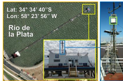
Fig. 1. Ubicación del teléfono celular (TC) y del mareógrafo del Servicio de Hidrografía Naval (SHN) frente a la costa del Río de la Plata. En el panel derecho se destaca con un recuadro verde la caja plástica que contiene al TC sobre la torre meteorológica.
