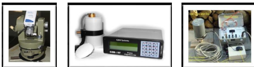
Fig. 5. Teodolito magnetico (izquierda), Magnetometro de precesion protonica (centro) y Variometro y electronica (derecha)
