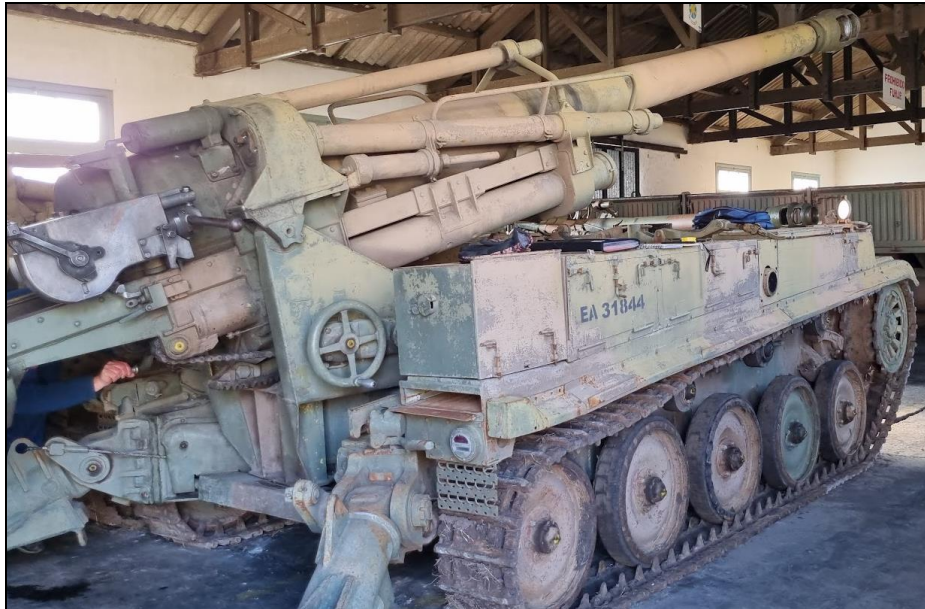
Figura 1: Vehículo original del chasis AMX-13 con un cañón SOFMA F3 155mm
